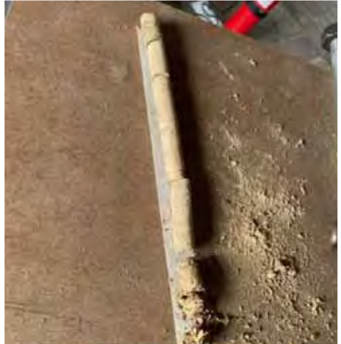
Boormonster. De losse korrels zijn van het spinthout (dicht bij de buitenkant).
