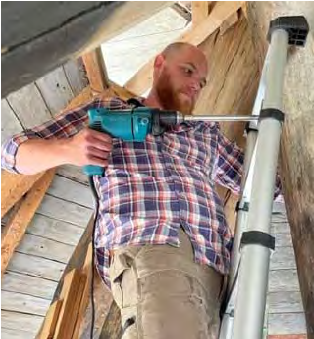
Foto Ton Timmer; Ezra van EAGM haalt een boormonster uit de standaard.
